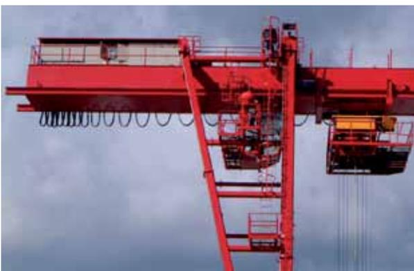
Nuestro sistemas festoon ofrecen las soluciones más flexibles para transportar cables planos o redondos y mangueras. Una amplia variedad de perfiles y componentes garantizan instalaciones fiables y adaptadas al entorno.
